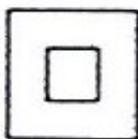
**Doppio isolamento.** Il prodotto elettrico che riporta questo simbolo in targa rappresenta un'apparecchiatura che può, anzi deve funzionare senza collegamento a terra, in quanto intrinsecamente sicura sotto il profilo della protezione contro la scossa elettrica provocata da cedimenti dell'isolamento principale. Trattasi quindi di apparecchi costruttivamente diversi da quelli predisposti per il collegamento a terra, ma altrettanto sicuri.
